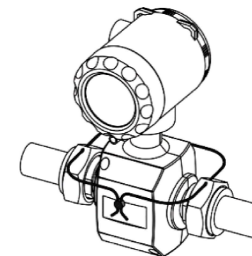
Рис. 9. Пломбирование муфтового расходомера
