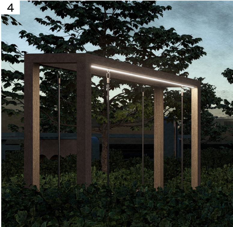
Лента, встроенная в профиле, 3000K, влагозащищенная, 12,5 метров
