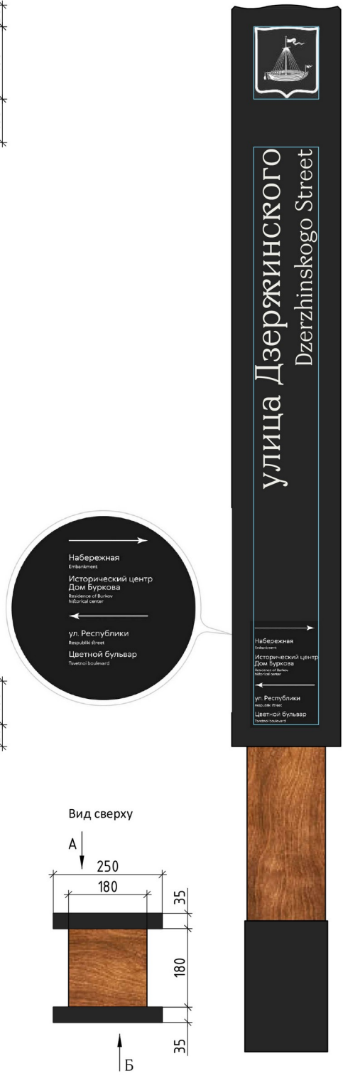
Рисунок 3.1. Навигационный пилон. Вариант 3 (с дополнительной навигацией)
